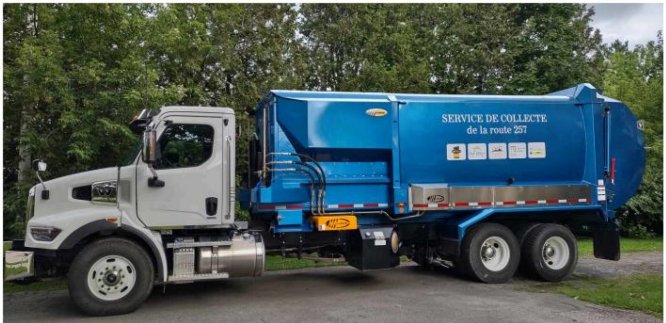
Camion 10 roues avec benne à chargement latéral de 30 mètres
